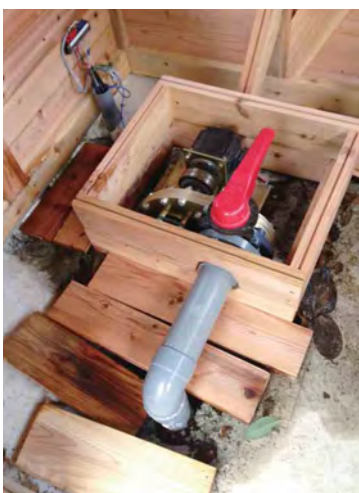
写真3 旭地区「水車の里つくば」の石田式ピコ水力発電機
