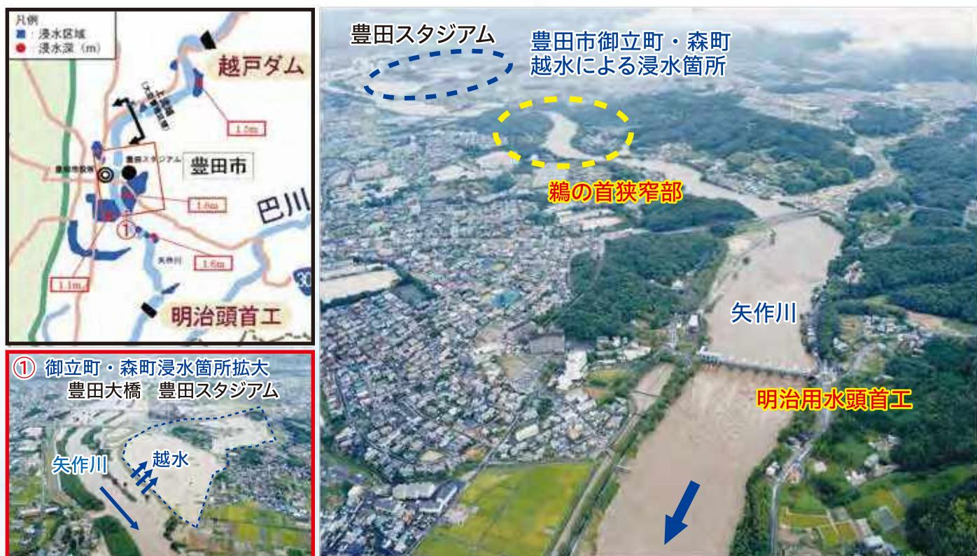
図2 矢作川「鶴の首」狭窄部上流区間のバックウォーターによる水位上昇と越水
