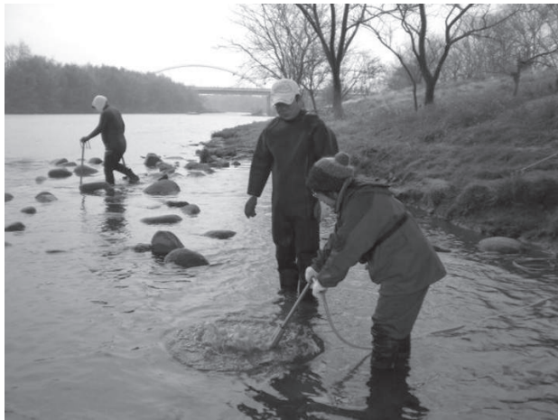
図 16 オオカナダモの根部を抜き取りやすいように開発されたエアースコップ.
