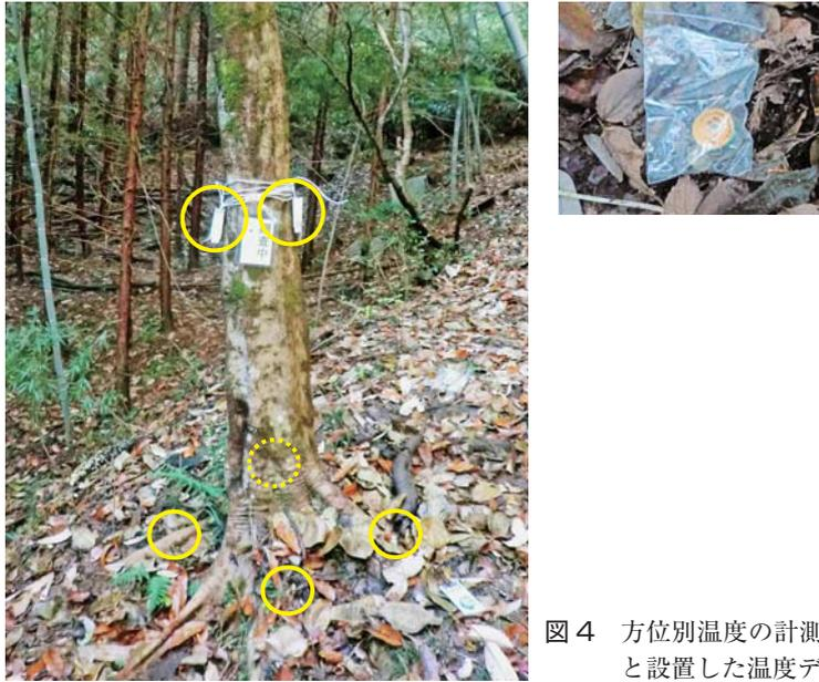
図4 方位別温度の計測箇所（○印 例：木番号 37）と設置した温度データロガー
