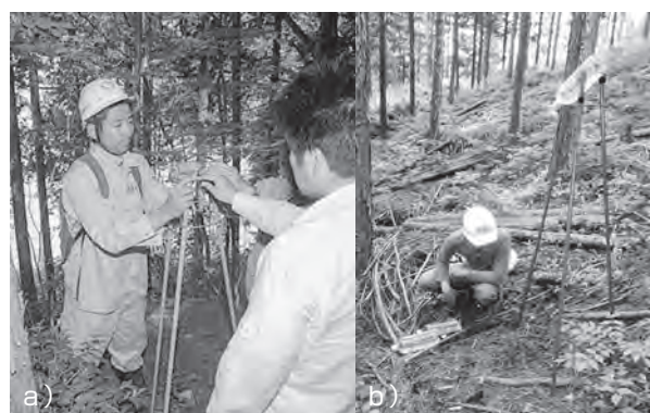
写真1 a) 現場で簡易散水装置を組み立てている様子と b) 組みあがった簡易散水装置を用いて散水実験をしている様子（両写真とも，中田良政氏撮影）
