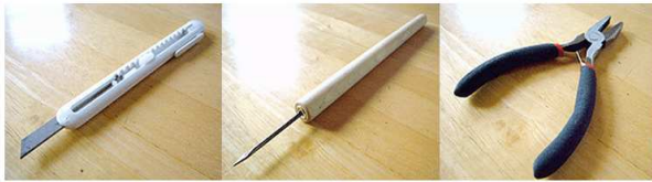
カッター、キリ、ペンチ ペットボトルをカットするためのカッターと、穴を開けるためのキリ。 あとは針金を使う場合はペンチやニッパーが必要だよ。
