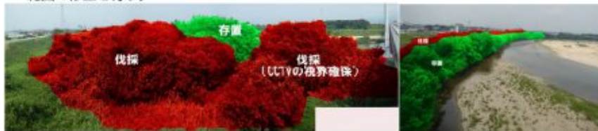
美矢井橋上流イメージ（優先度A、流下能力不足の区間）
