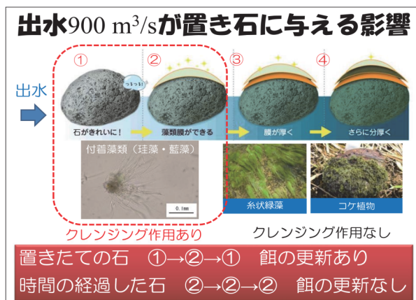
図40 付着藻類の変化からみた出水(900 m 3 /s)と礫の安定との関係。
